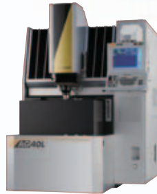
リニアモータ駆動 高速・高性能 形彫り放電加工機 AG40L
