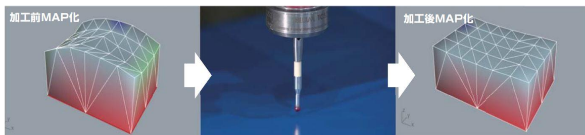
写真:機上で MAP 化されたワーク (左:加工前 右:加工後)
