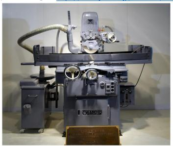
本機は、当社が1953(昭和28)年に製作した PSG6B 形の初号機です。日本の高度経済成長期の機械工業の発展を、1/1000mm 台の精密加工を実現するという確かな精度で支えた歴史的工作機械です。テーブルの駆動装置に油圧シリンダを採用するなど、現在普及している平面研削盤の基本構造を画した最初の平面研削盤です。
