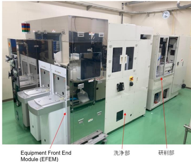
図3：Si貫通電極ウェーハ用全自動研削装置の外観（左）、レイアウト（右）。ウェーハ搬送システムである「Equipment Front End Module（EFEM）」と洗浄部ではそれぞれのロボットがウェーハを搬送しステージ間を移動していく。研削部ではインデックステーブルが回転することで粗研削、仕上げ研削へとウェーハが移動する。
